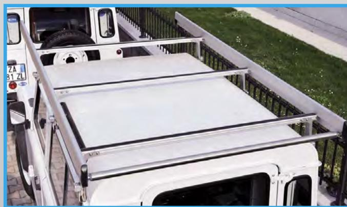
Einbau mit Regalen und Schubladenkästen und einem Dachträger in einem Land Rover.
