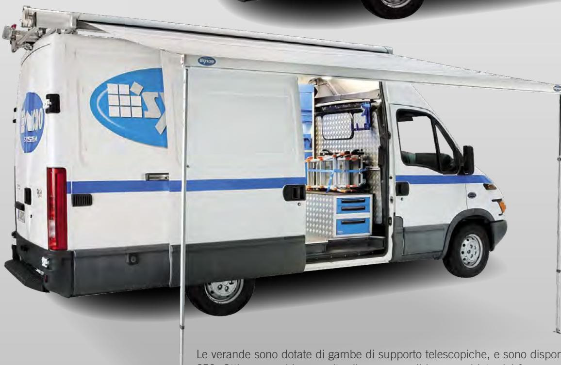
Le verande sono dotate di gambe di supporto telescopiche, e sono disponibili in profondità da cm 250. Ottime per chi necessita di una zona di lavoro sul lato del furgone, al riparo da sole e dalle intemperie.
