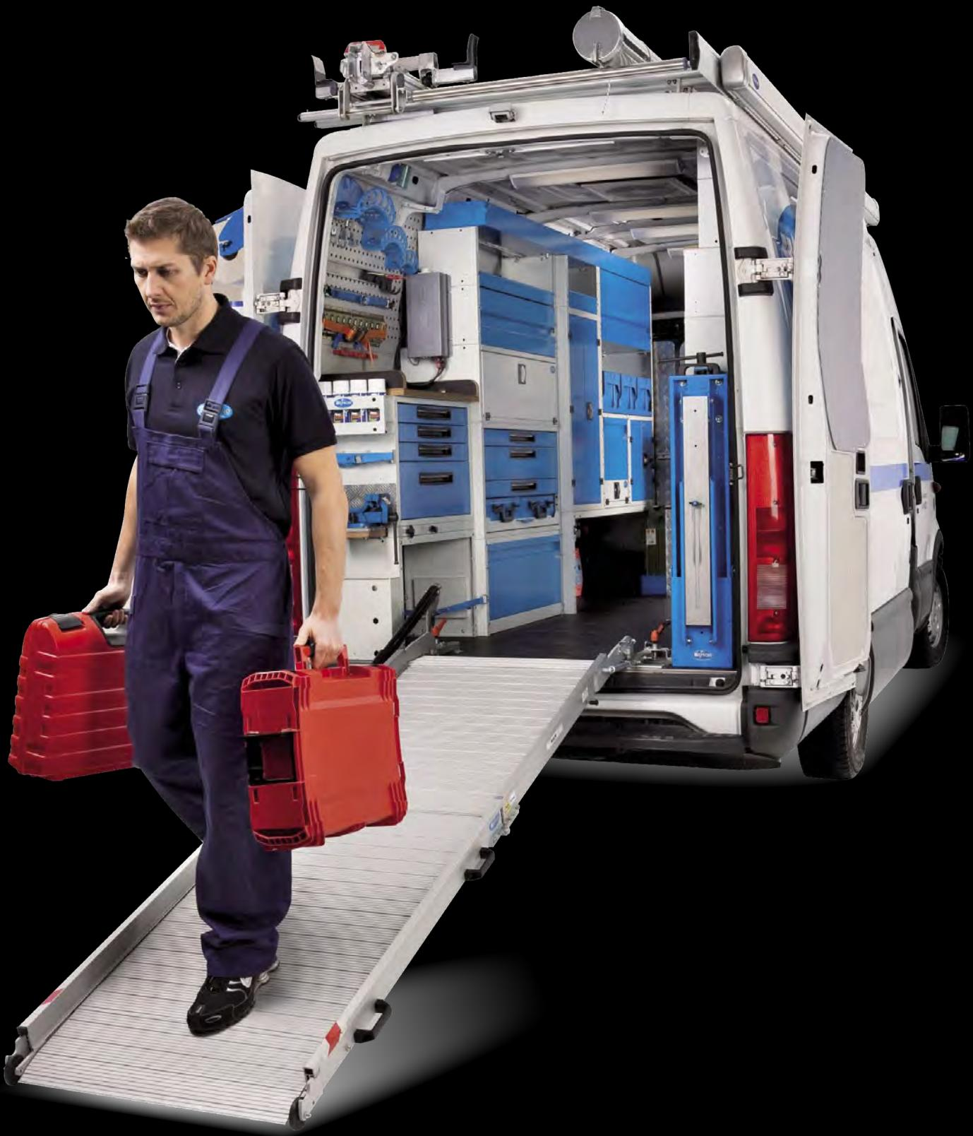
Le nuove rampe di carico Syncro System permettono di caricare e scaricare senza fatica, in maniera sicura e senza rischi, carichi di peso anche notevole. Possono essere aperte e poste a terra con uno sforzo minimo, grazie alle molle a gas che fanno da contrappeso.
