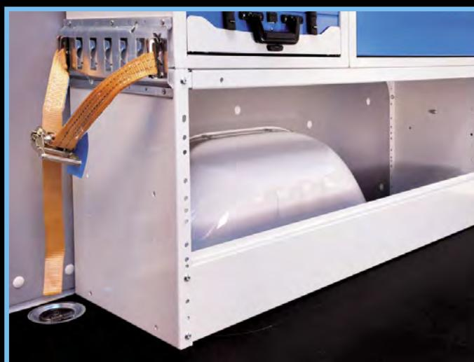
Copripassaruota aperto. Il tipo più semplice di copripassaruota, con i tre angolari della stessa dimensione.
