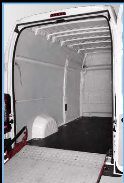
Questo modello è caratterizzato dall'apertura orizzontale per il carico e dalla possibilità di apertura verticale, che fa ruotare lateralmente il corpo della rampa quando è necessario l'accesso al vano di carico, ad es. per caricare con un carrello elevatore. Disponibili oltre 500 modelli con portate fino a 1.500 kg.
